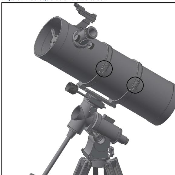
Figura 9. Deslize o tubo e aperte os manípulos dos anéis..
