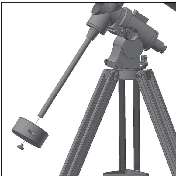
Figure 6. Coloque o contrapeso e o parafuso de segurança.
