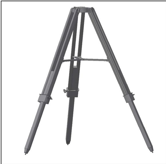
Figura 2. Montagem do tripé.
