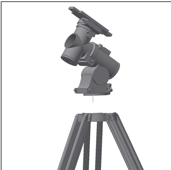
Figure 4. Coloque a cabeça equatorial no topo do tripé.
